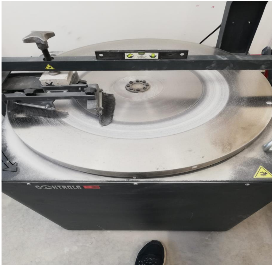
Slika 7.9. Uređaj za ispitivanje habanja-Bohmeov disk
