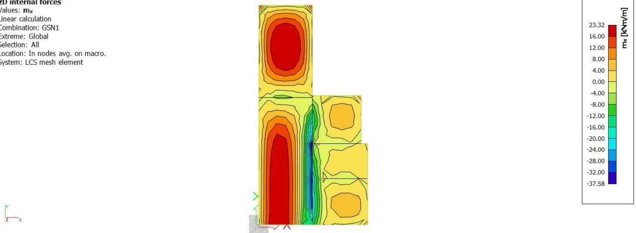
Slika 6.14 Moment savijanja M_{Ed,x} (kNm/m) za GSN-1
