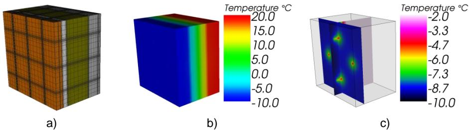
**Slika 2.** Model korišten u računalnom programu AnTherm (a) i raspodjela temperature u elementu (b) i raspodjela temperature na pričvrsnicama (c)
