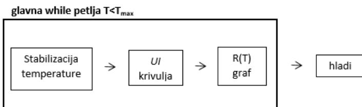
**Slika 1.** Koncept mjerjenja električnog otpora uzorka na temperaturama višima od sobne,  $T_{\max}$  je konačna temperatura mjerjenja
