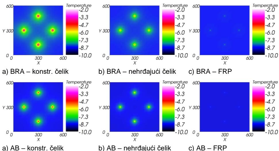
Slika 4. Raspodjela temperature na vanjskoj površini toplinske izolacije
