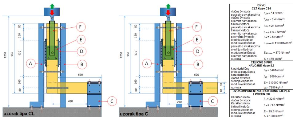
(A i B-čelični okvir, C-čelična papuča, D-čelični valjci, E-čelične ploče, F-čelično sedlo)
