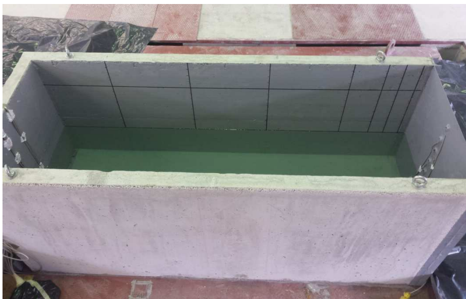
Slika 5.2. Fotografija rezervoara R2 spremnog za ispitivanje
