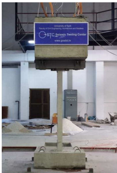
Slika 2.23. Fotografija karakterističnog stupa spremnog za ispitivanje
