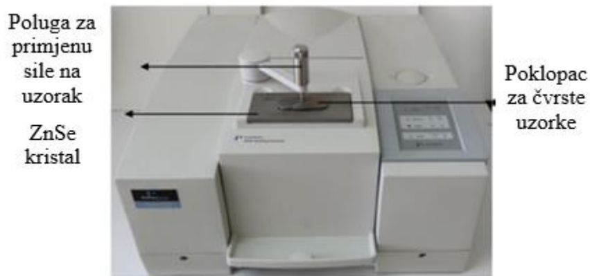
Slika 1.14. Spektrometar Perkin-Elmer Spectrum One s dodatkom za snimanje HATR tehnikom. 30
