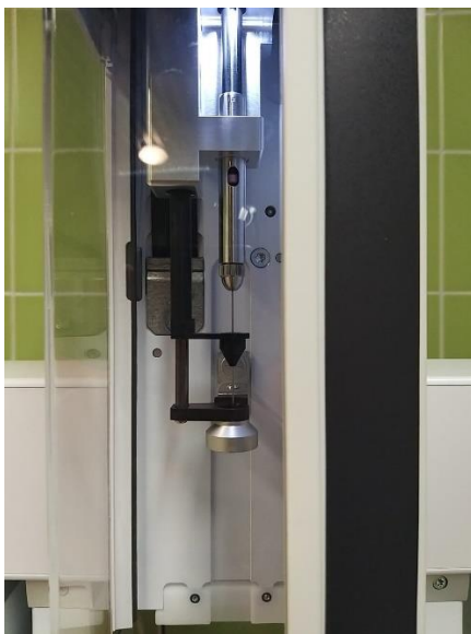
Slika 27. Automatski sustav za HS-SPME.
