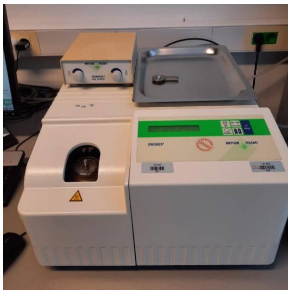
Slika 17. Diferencijalni pretražni kalorimetar
