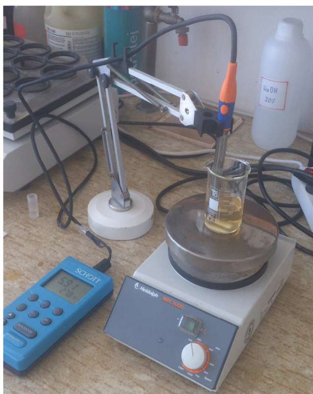
Slika 3. Aparatura za dobivanje koloidnog srebra
