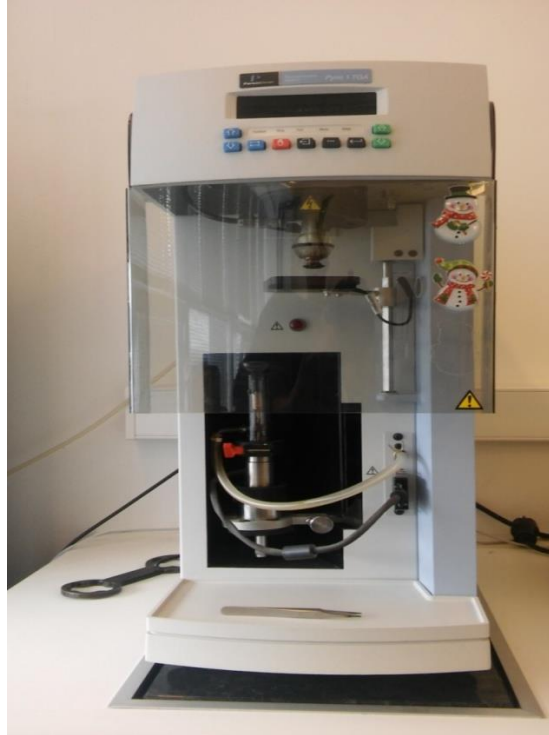
Slika 2.1. Termogravimterijski uređaj Pyris 1 TGA (Perkin Elmer)
