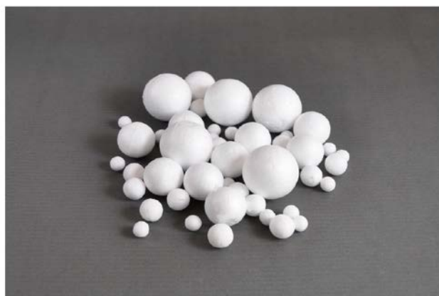
Slika 6. Kuglice pjenastog polistirena 10
