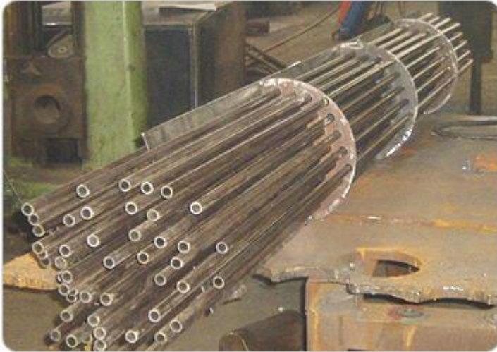
Slika 4. Cijevni snop u fazi izrade cijevnog izmjenjivača topline 9
