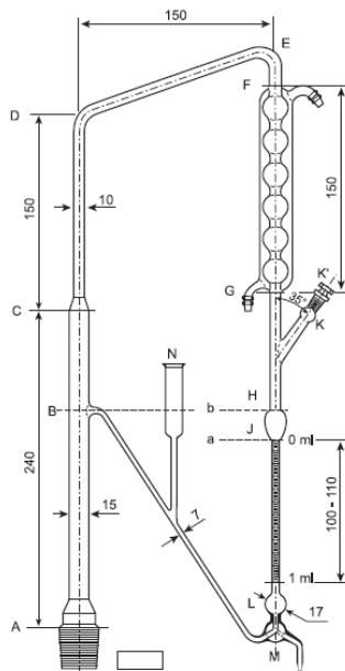
Slika 4. Aparatura za destilaciju po Europskoj farmakopeji 5.0 (shematski prikaz s dimenzijsama u mm)
