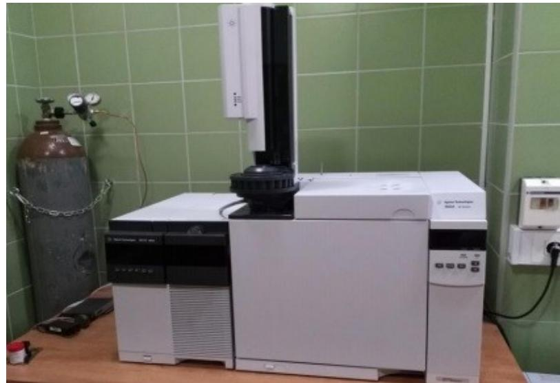
Slika 9. Vezani sustav plinska kromatografija – spektrometrija masa; Agilent Technologies 7820A/5977E
