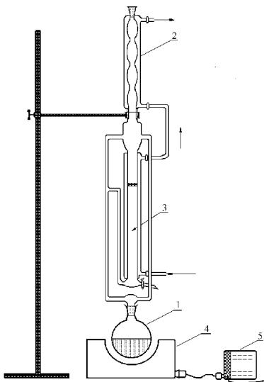
Slika 8. Shematski prikaz aparature za vodenu destilaciju po Clevengeru: 1 – tikvica s okruglim dnom, 2 – vodeno hladilo po Allihnu, 3 – središnji dio aparature za destilaciju, 4 – kalota, 5 – otpornik promjenjive struje (reostat)
