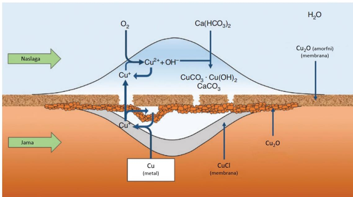
**Slika 1.** Mehanizam korozije bakra,<sup>51</sup>
