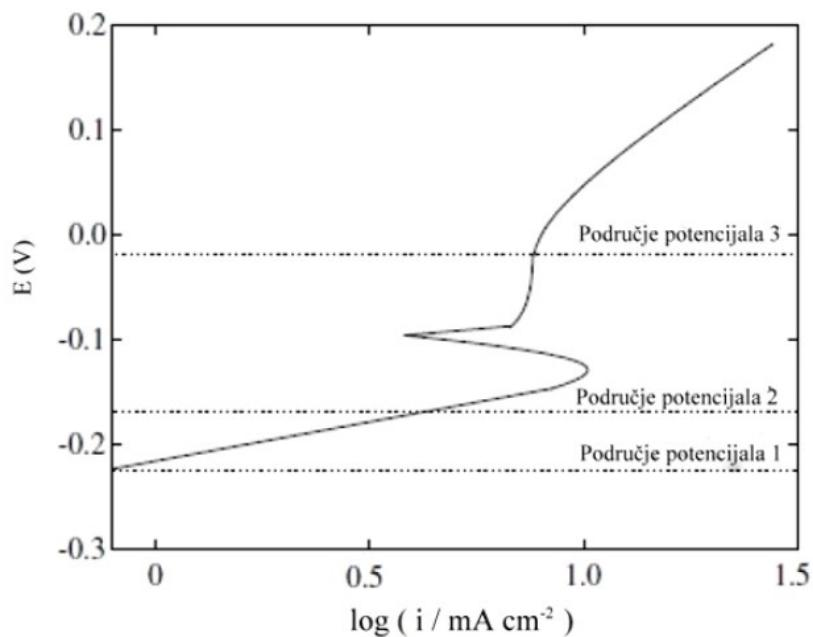
**Slika 19.** Tipična anodna polarizacijska krivulja za bakar.
