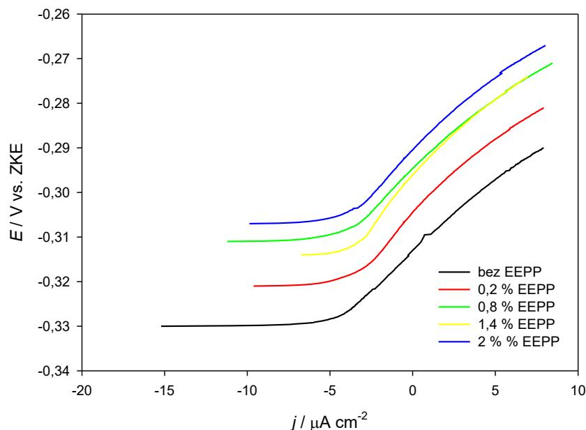
**Slika 17.** Polarizacijske krivulje bakra u  $0,5 \text{ mol dm}^{-3}$  otopini NaCl bez i uz dodatak 75 %-tnog etanolnog ekstrakata *Padina pavonica* u različitim koncentracijama pri  $30^\circ\text{C}$ .
