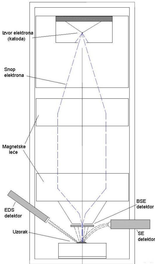
**Slika 5.** Shema osnovnih elemenata SEM-a.
