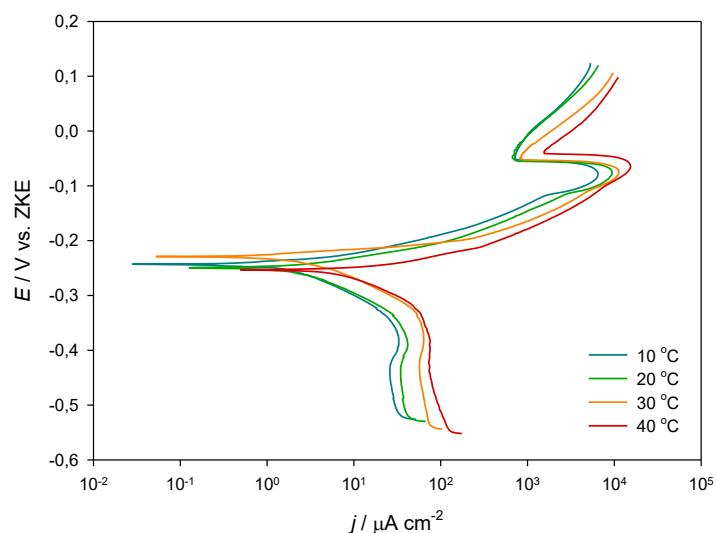
**Slika 22.** Anodne i katodne krivulje polarizacije bakra u  $0,5 \text{ mol dm}^{-3}$  otopini NaCl bez i uz dodatak 75 % etanolnog ekstrakta Padina pavonica u volumenskoj koncentraciji 1,4 % pri različitim temperaturama.
