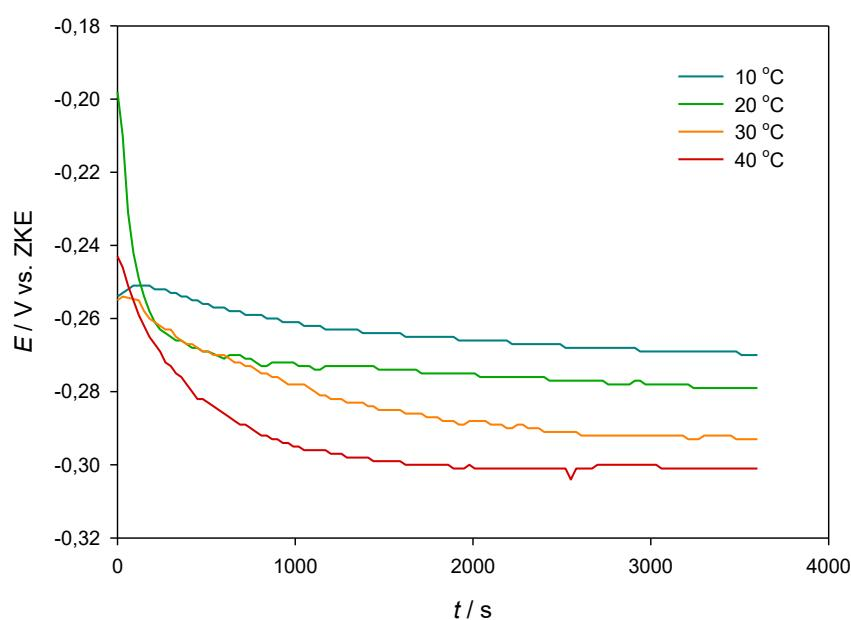
**Slika 20.** Ovisnost potencijala otvorenog kruga bakra u  $0,5 \text{ mol dm}^{-3}$  otopini NaCl bez i uz dodatak 75 % etanolnog ekstrakta Padina pavonica u volumenskoj koncentraciji 1,4 % pri različitim temperaturama o vremenu.
