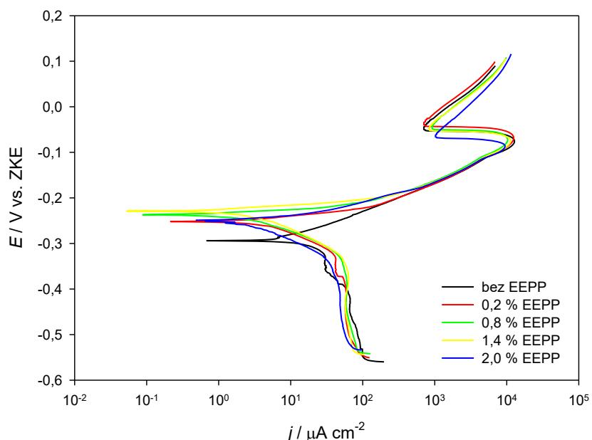
**Slika 18.** Anodne i katodne krivulje polarizacije bakra u  $0,5 \text{ mol dm}^{-3}$  otopini NaCl bez i uz dodatak 75 %-tnog etanolnog ekstrakata *Padina pavonica* u različitim koncentracijama pri  $30^\circ\text{C}$ .
