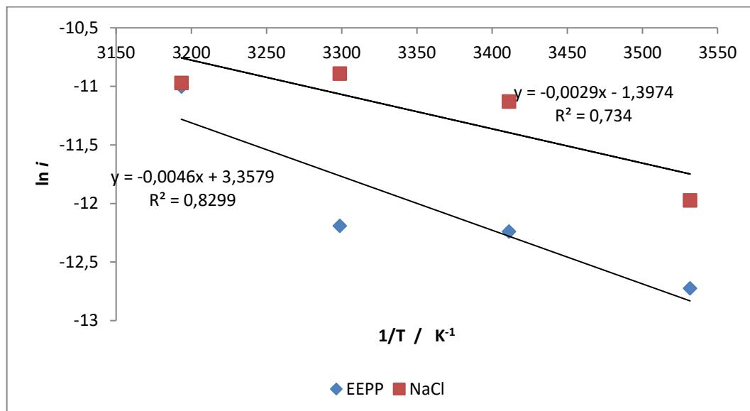
**Slika 25.** Određivanje energije aktivacije za bakar u  $0,5 \text{ M}$  otopini  $\text{NaCl}$  bez ( $\blacksquare$ ) i u prisustvu inhibitora (EEPP) ( $\blacklozenge$ ).
