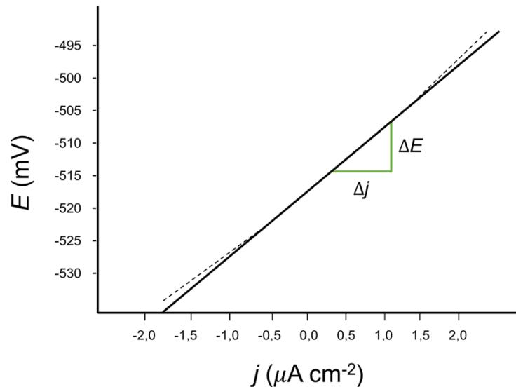
**Slika 7.** Određivanje polarizacijskog otpora iz nagiba polarizacijske krivulje u blizini koroziskog potencijala.
