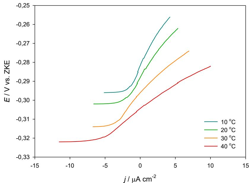
**Slika 21.** Polarizacijske krivulje bakra u  $0,5 \text{ mol dm}^{-3}$  otopini  $\text{NaCl}$  bez i uz dodatak 75 % etanolnog ekstrakta *Padina pavonica* u volumenskoj koncentraciji 1,4 % pri različitim temperaturama.
