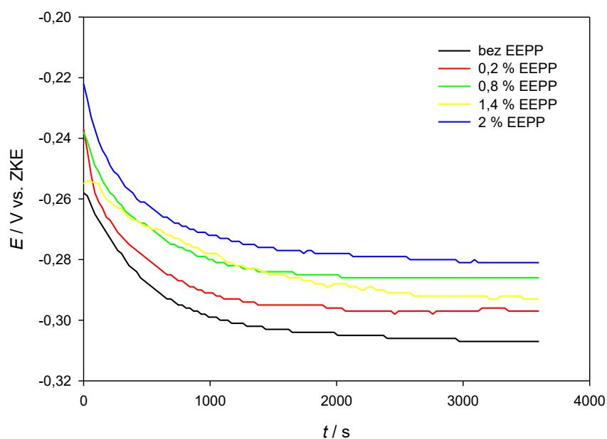
**Slika 16.** Ovisnost potencijala otvorenog kruga bakra u 0,5 mol dm<sup>-3</sup> otopini NaCl bez i uz dodatak 75 % etanolnog ekstrakta *Padina pavonica* u volumenskim koncentracijama 0,2 %, 0,8 %, 1,4 % i 2 % pri 30 °C o vremenu.
