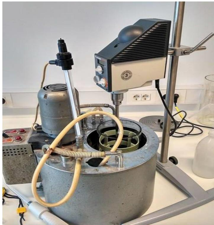
**Slika 7.** Termostatirani kotlasti reaktor
