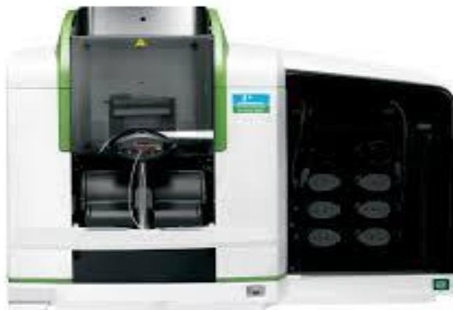
**Slika 9.** Uređaj za atomsku apsorpcijsku spektrometriju Perkin Elmer PinAAcle 900F AAS<sup>50</sup>
