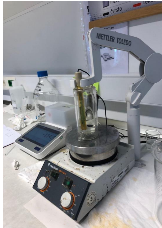
Slika 12. Aparatura za potenciometrijsko mjerenje.
