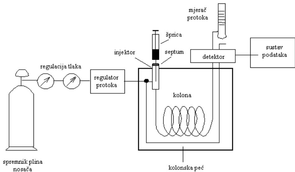
*Slika 4. Shematski prikaz plinskog kromatografa (20)*
