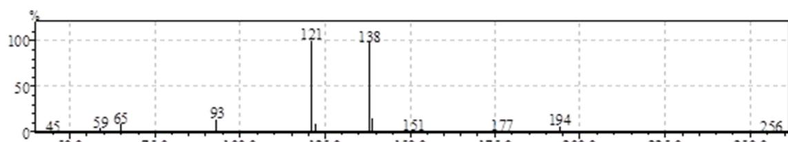
**Slika 13.** Karakterističan spektar masa za butilparaben u uzorku 1 (m/z 121, 138, 93, 194)
