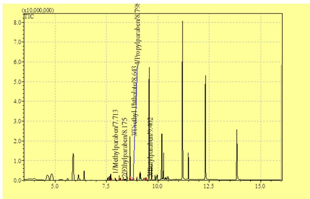
**Slika 9.** Ukupni ionski kromatogram uzorka br.1 analiziranog GC-MS tehnikom. Os x prikazuje vrijeme zadržavanja uzorka u koloni (retencijsko vrijeme, RT) dok os y prikazuje intenzitet tvari proporcionalan koncentraciji tvari. U ispitivanom je uzorku dokazano prisustvo metilparabena (RT=7,713), etilparabena (RT=8,175), propilparabena (RT=8,798) i butilparabena (RT=9,402) kao i dietilftalata (RT=8,43).
