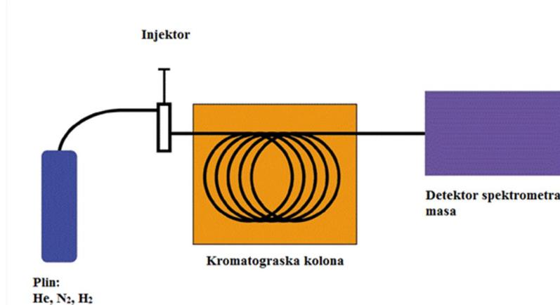
Slika 3. Shematski prikaz osnovnih dijelova vezane GC-MS tehnike (33).
