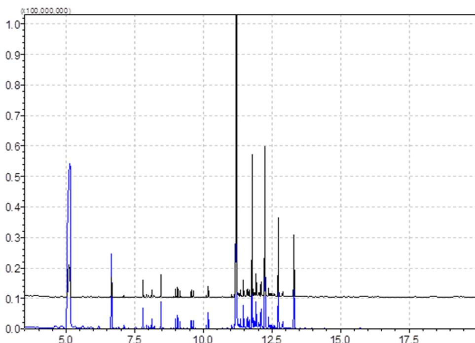
**Slika 22.** Usporedba rezultata analize istog uzorka br. 5 koji nije prethodno maceriran (kromatogram označen crnom bojom) i uzorka br. 5 koji jest prethodno maceriran (kromatogram označen plavom bojom) u kojima nije dokazano prisustvo ni parabena niti ftalata.
