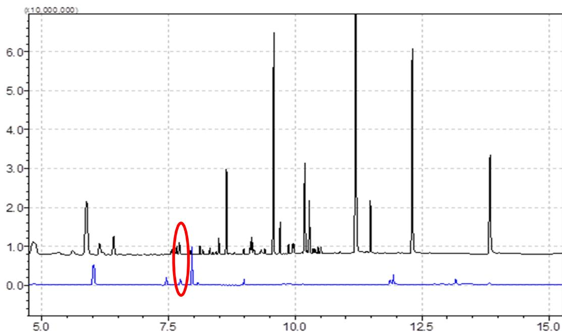
**Slika 16.** Usporedba rezultata analize uzorka br. 1 (kromatogram označen crnom bojom) i uzorka br. 4 (kromatogram označen plavom bojom) s karakterističnim signalom za metilparaben ( $RT=7,7$ ) detektiranim u oba uzorcima.
