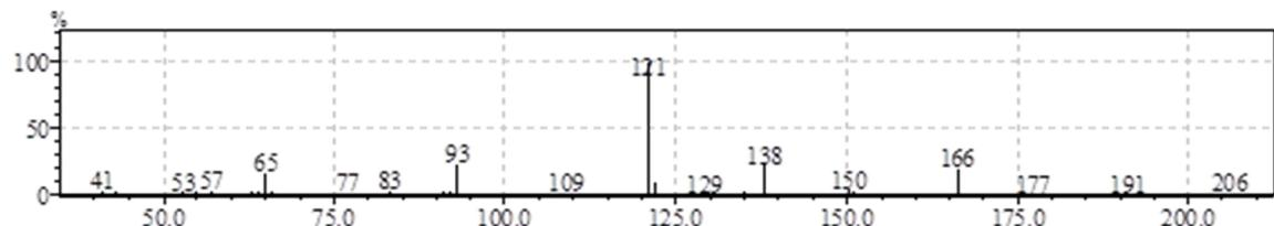
**Slika 11.** Karakterističan spektar masa za etilparaben dokazan u uzorku br. 1 (m/z 121, 138, 93, 65)
