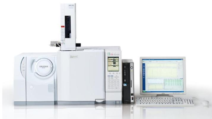
**Slika 7.** Plinski kromatograf sa spektrometrom masa; Shimadzu GCMS-QP2010 (35).
