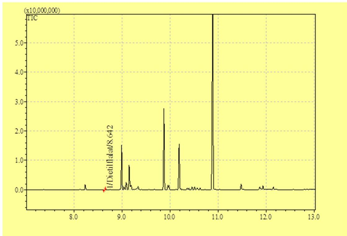
**Slika 20.** Ukupni ionski kromatogram uzorka br. 24 analiziranog GC-MS tehnikom u kojem je dokazano prisustvo dietilftalata ( $RT=8,642$ ).
