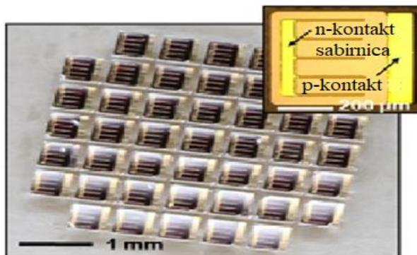
**Slika 14.** Višeslojna InGaP/GaAs/InGaAs solarna ćelija<sup>26</sup>
