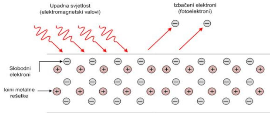
**Slika 2.** Fotoelektrični efekt <sup>4</sup>
