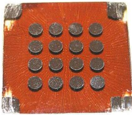
Slika 11. QD solarna čelija<sup>19</sup>
