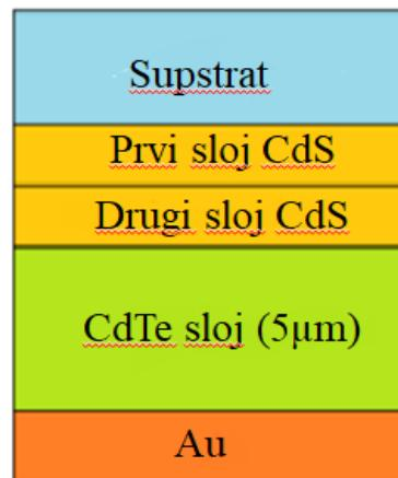
**Slika 9.** Dvoslojna CdTe solarna ćelija<sup>15</sup>
