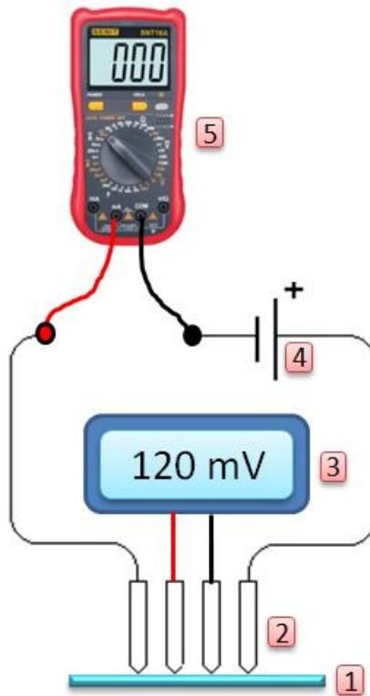
**Slika 22.** Shematski prikaz mjerena površinske otpornosti: 1-vodljivo stakalce, 2-kontakti sonde, 3-precizni digitalni voltmetar, 4-izvor istosmjernog napona, 5-digitalni miliampermetar
