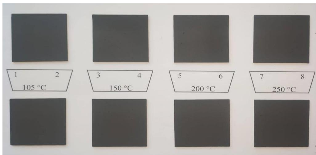
Slika 21. Grafitni filmovi na stakalcima pečeni pri temperaturama od  $105\text{ }^{\circ}\text{C}$ ,  $150\text{ }^{\circ}\text{C}$ ,  $200\text{ }^{\circ}\text{C}$  i  $250\text{ }^{\circ}\text{C}$
