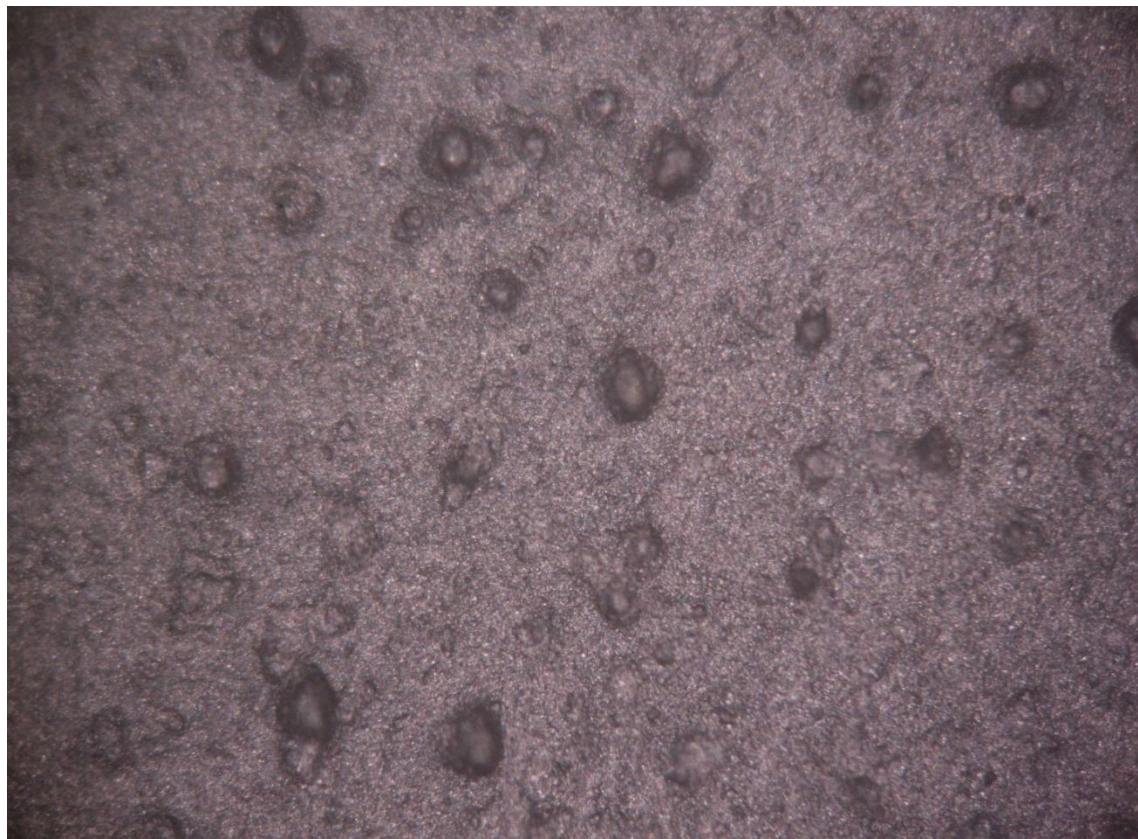
**Slika 28.** Površina grafitnog sloja pečenog pri  $250\text{ }^{\circ}\text{C}$  pri uvećanju od 200x
