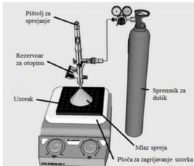
Slika 17. Oprema za sprej tehniku<sup>38</sup>
