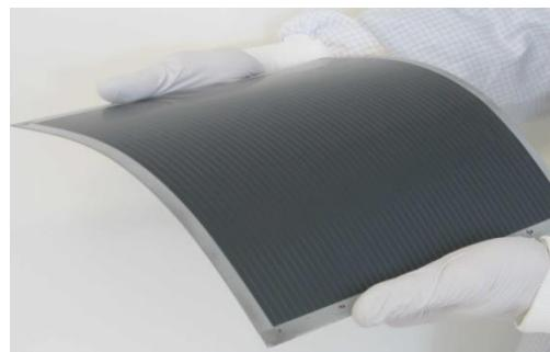
Slika 10. CIGS solarna ćelija<sup>17</sup>
