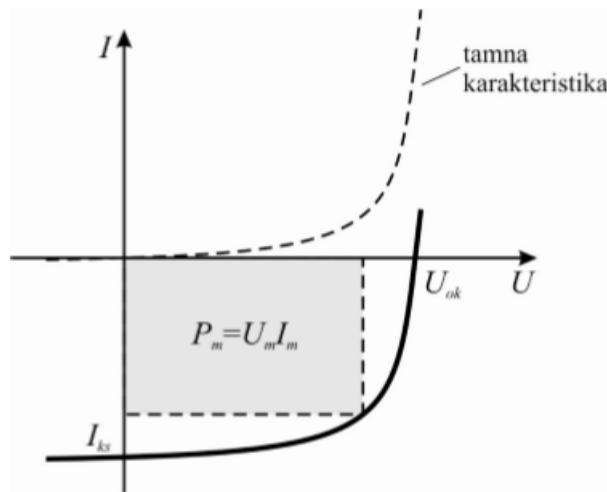
**Slika 4.**  $I$ - $U$  karakteristika neosvjetljene i osvjetljene solarne čelije <sup>6</sup>
