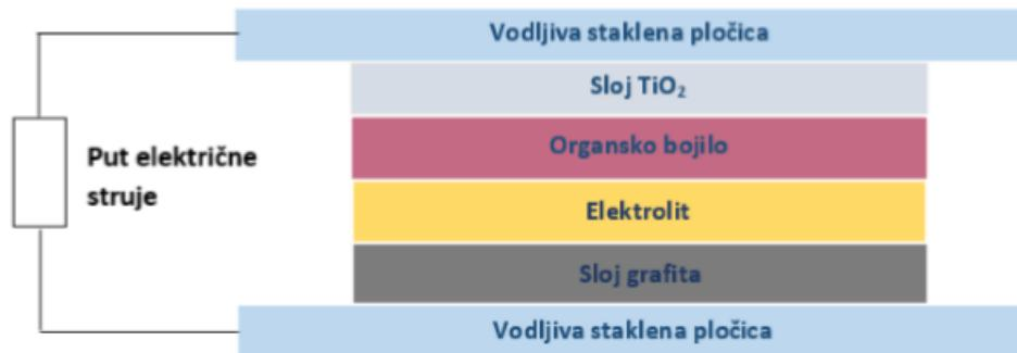
**Slika 15.** Struktura Grätzelove solarne ćelije <sup>25</sup>
