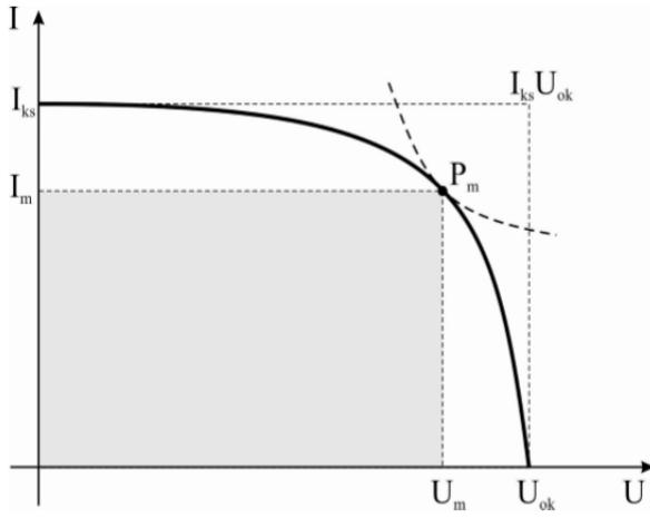
Slika 5. Osnovni parametri solarne čelije <sup>7</sup>
