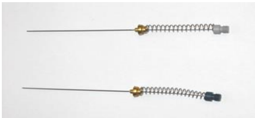
Slika 8. Vlakna s ovojnica DVB/CAR/PDMS (sivo vlakno) i PDMS/DVB (plavo vlakno) 21
