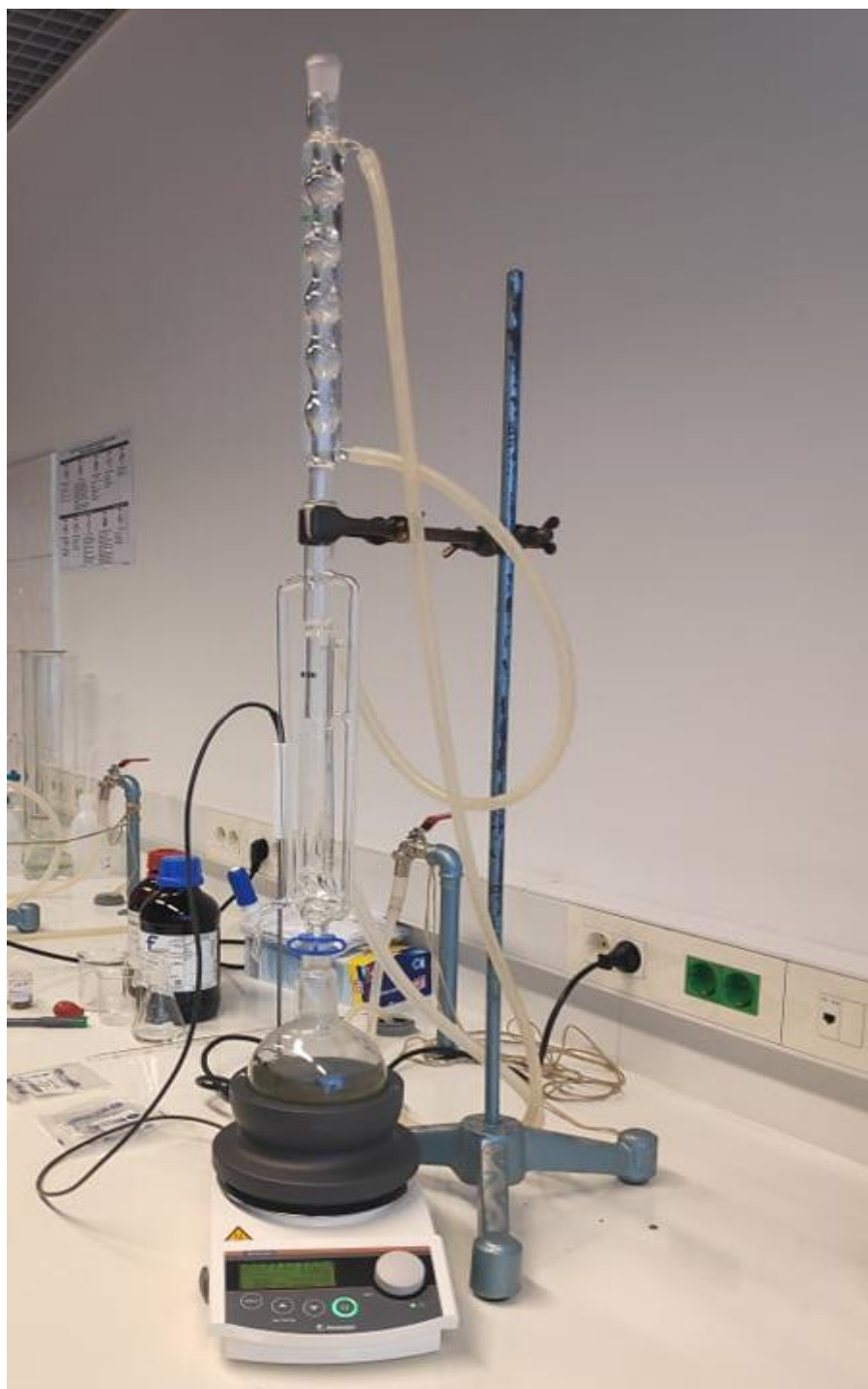
Slika 10. Modificirana aparatura prema Clevenger-u.
