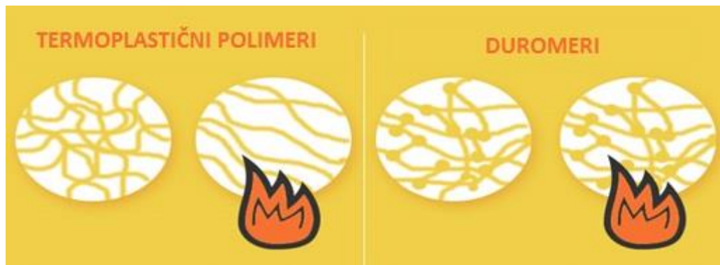
Slika 2. Ponašanje termoplastičnog polimera i duromera tijekom zagrijavanja. 6
