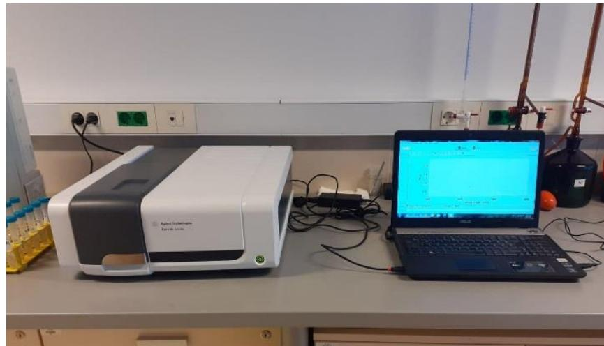
**Slika 11.** Spektrofotometar The Agilent Cary 60
