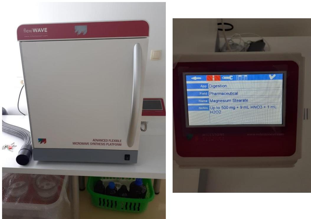
**Slika 7.** Mikrovalna peć za digestiju
