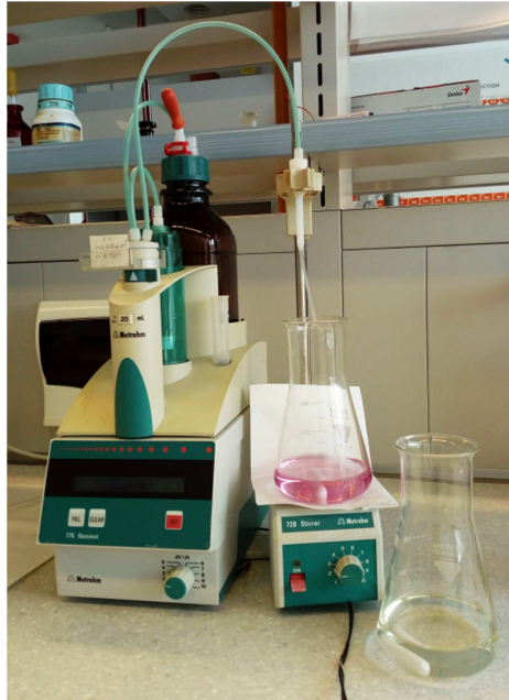
Slika 2.2. Promjena boje pri kompleksometrijskom određivanju cinka
