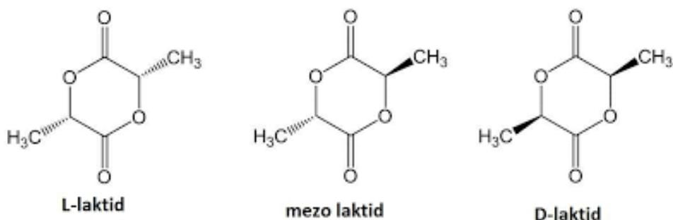
**Slika 10.** Optički stereoizomeri laktida<sup>14</sup>
