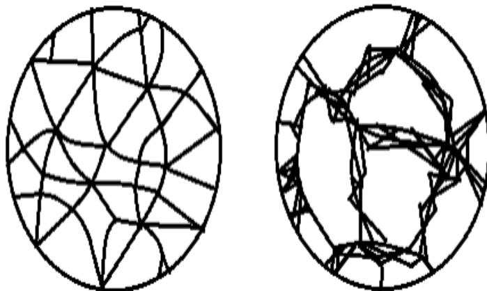
**Slika 4., Gel i makroporozni izmjenjivač**
