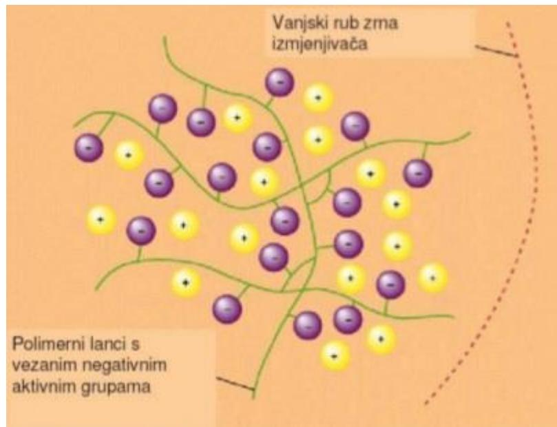
Slika 3., Shematski prikaz strukture ionskog izmjenjivača
