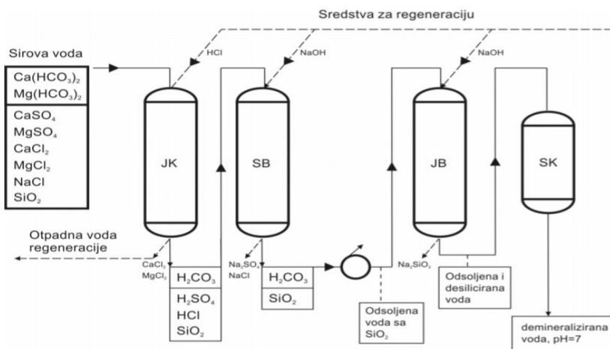
Slika 9., Shematski prikaz postrojenja za demineralizaciju vode
