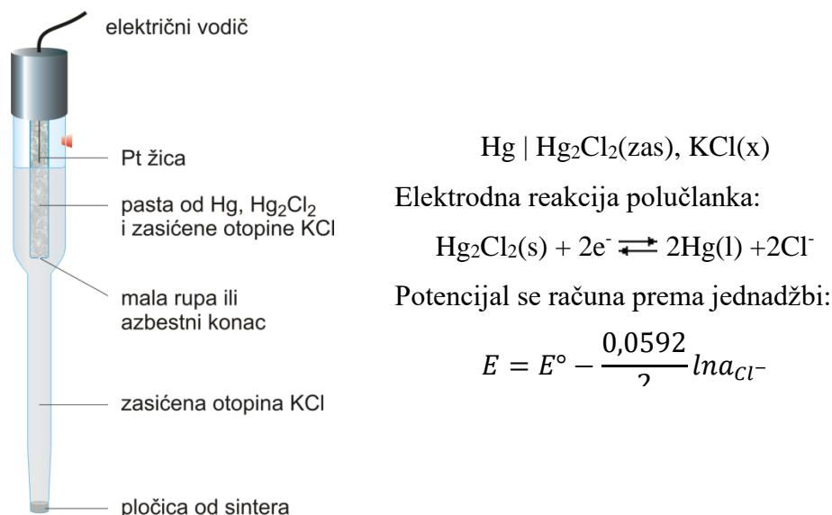
**Slika 7.** Shematski prikaz kalomel elektrode<sup>17</sup>
