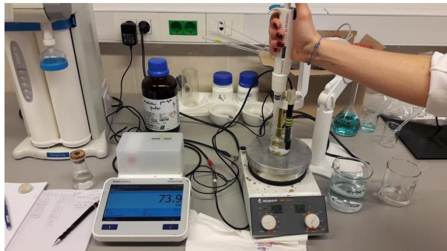
**Slika 9.** Aparatura za mjerjenje potencijala
