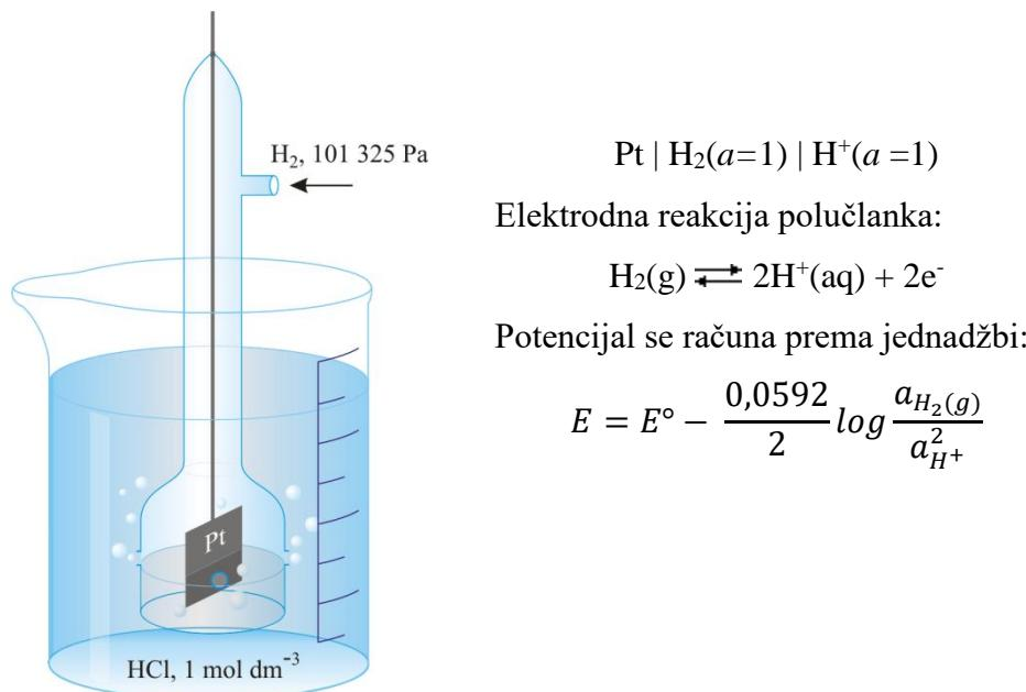
**Slika 6.** Shematski prikaz standardne vodikove elektrode<sup>17</sup>
