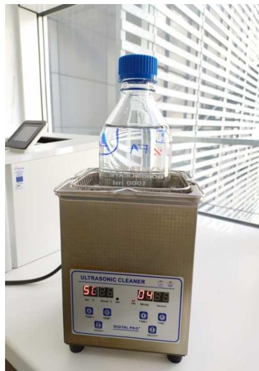
**Slika 3.** Ultrazvučna kupelj (JP-010, Digital Pro)
