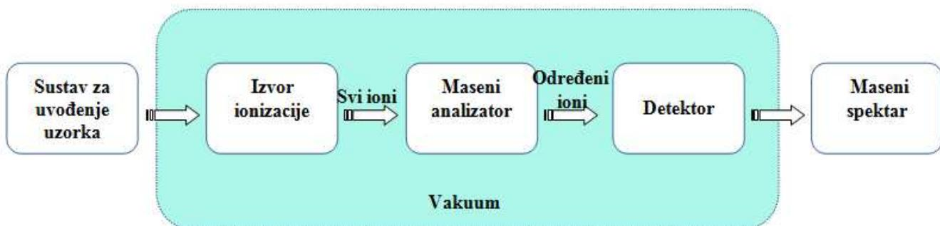
**Slika 1.5.** Shematski prikaz komponenti masenog spektrometra
