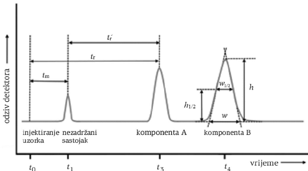
**Slika 1.4.** Prikaz kromatograma s kromatografskim parametrima<sup>32</sup>
