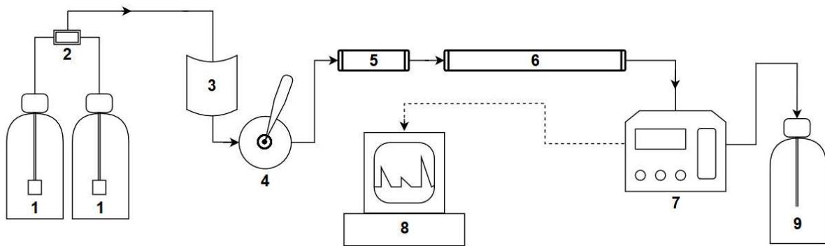
**Slika 1.3.** Shematski prikaz komponenti HPLC uređaja: spremnici pokretne faze (otapala) s filterom (1); otplinjač (2); crpka (3); injektor uzorka (4); pretkolona (5); kolona (6); detektor (7); računalno za obradu podataka (8); otpadni spremnik (9).<sup>38</sup>
