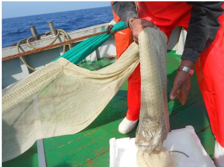
Slika 3.12. Manipulacija pokrovnom vrećom postavljenom iznad selektivnog panela.
