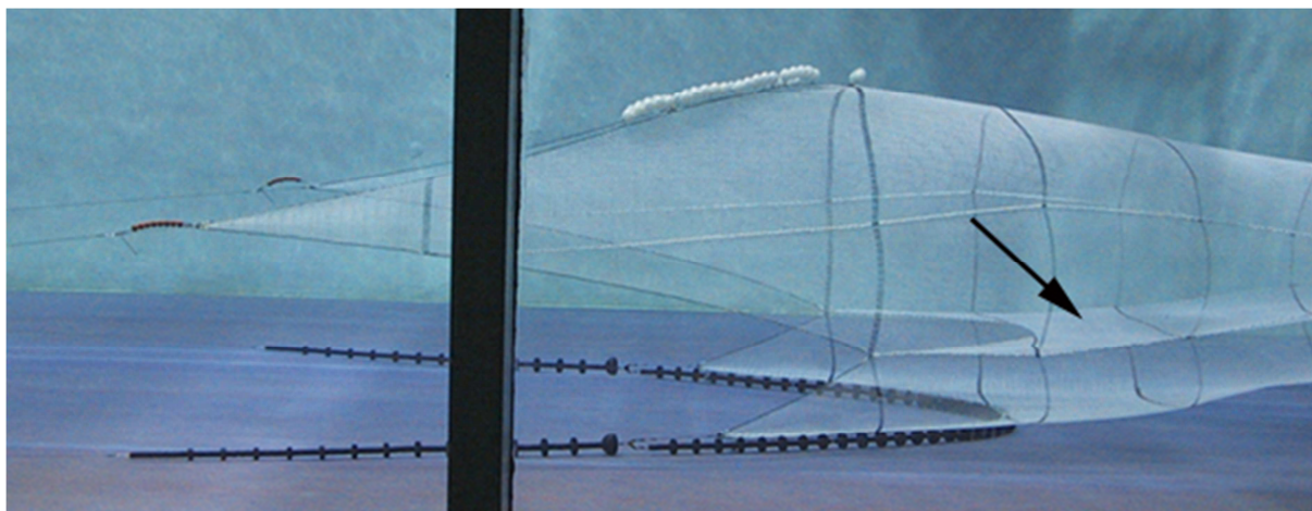
Slika 2.15. Horizontalni panel umetnut u koću radi separacije ugotice od bakalara (Izvor: http://www.crimond.com/selectivity.htm ).
