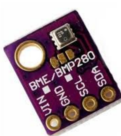
Slika 16. Prikaz izgleda "BME280"
