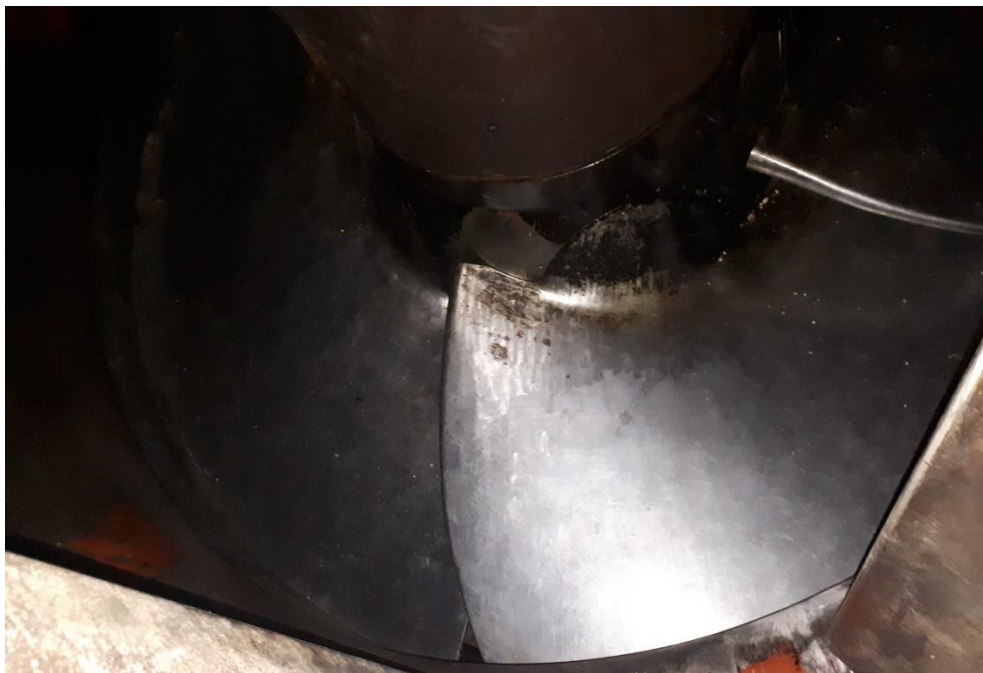
Slika 4. 29. Lopatice radnog kola [15]
