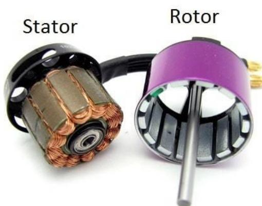
Slika 3.5. Outrunner istosmjerni motor bez četkica
