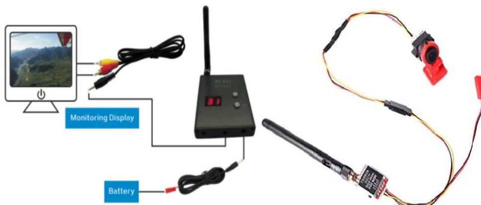
Slika 6.4. Pojednostavljena shema spoja FPV opreme
