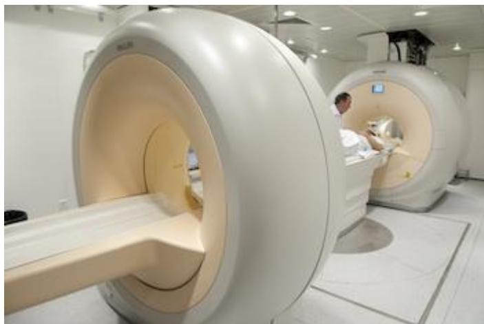
Slika 8 Philips Healthcar's PET/MR uređaj za skeniranje cijelog tijela
