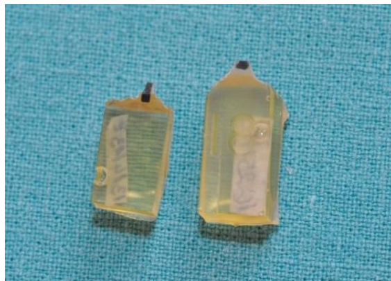
Slika 17. Izgled bloka s malom piramidom na vrhu
