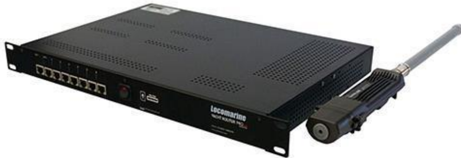
Slika 26. Prikaz Yacht Router PRO-a spremnog za ugradnju [26]
