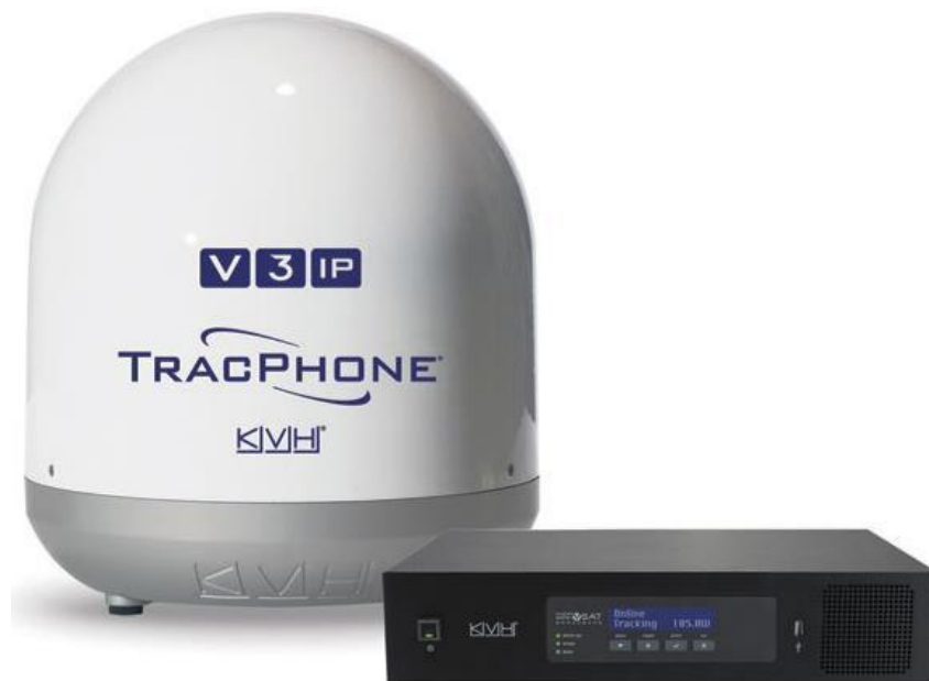
Slika 27. Komponente KVH TracPhone V3-IP komunikacijskog sustava [27]
