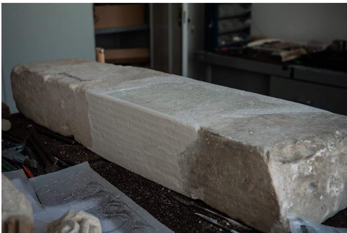
Slika 75 Prikaz vanjske bočne i stražnje strane nakon klesanja (autor: Rina Dubravec)
