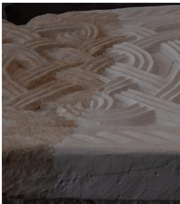
Slika 83 i Slika 84 Prikaz spoja donjeg originalnog ulomka s rekonstrukcijom prije i poslije nadopunjavanja Acrystalnom smjesom (autor: Rina Dubravec)
