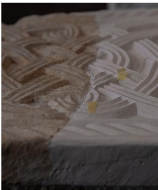
Slika 83 i Slika 84 Prikaz spoja donjeg originalnog ulomka s rekonstrukcijom prije i poslije nadopunjavanja Acrystalnom smjesom (autor: Rina Dubravec)
