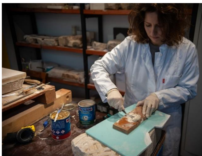
Slika 41 Miješanje komponenata ljepila (autor: Mladen Matijaca)
