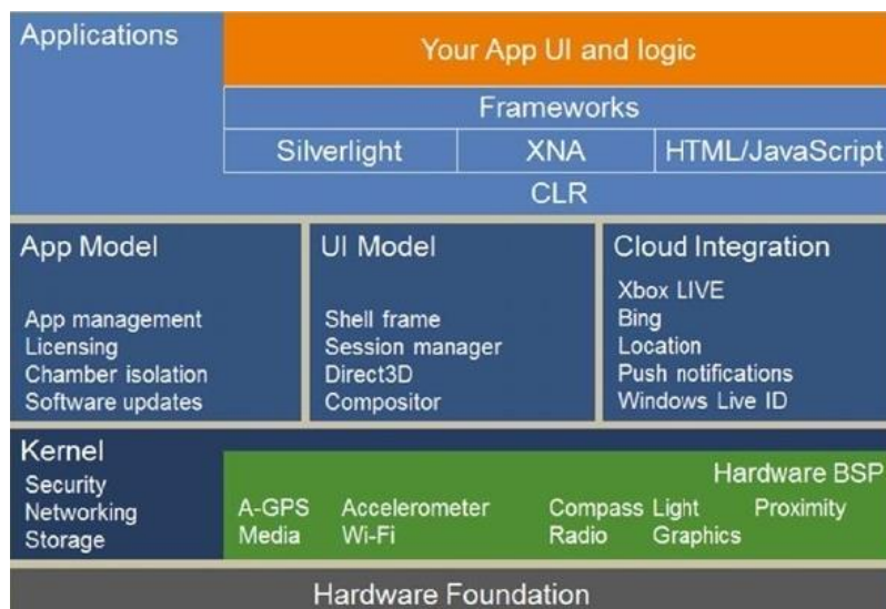
Slika 33: Arhitektura operativnog sustava Windows Mobile
