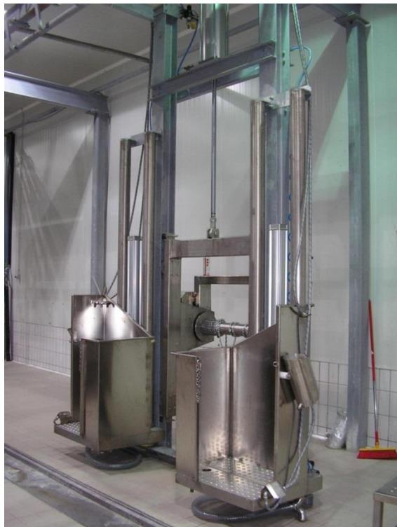
**Slika 9: Pneumatski stroj za skidanje kože goveda**
