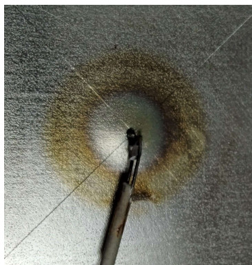
Slika 3.4 Termopar zavaren na donjoj strani uzorka
