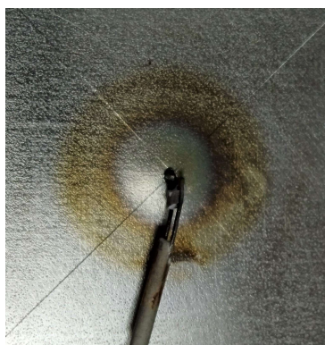
Slika 3.4 Termopar zavaren na donjoj strani uzorka
