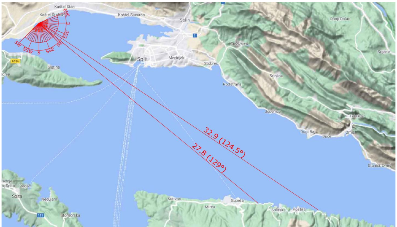
Slika 2.19 Skica za izračun efektivne duljine privjetrišta za centralni smjerove E,ESE,SE,SSE
