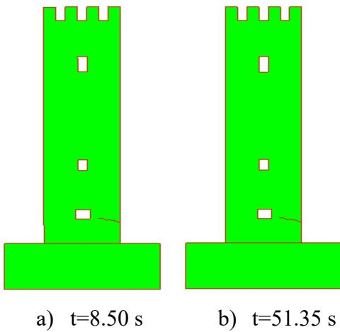
**Slika 87.** Pukotine za ubrzanje  $a = 0.80 \text{ g}$
