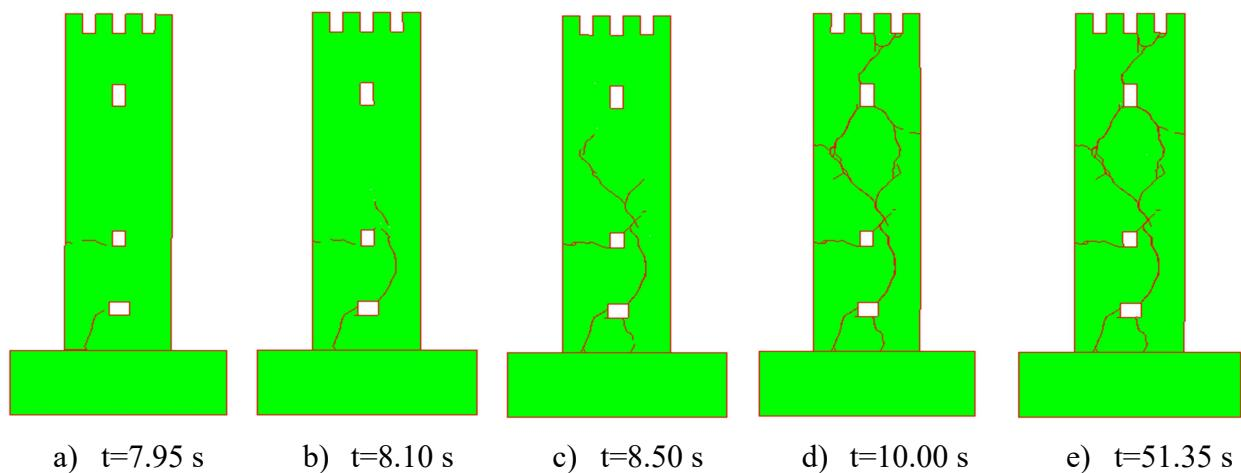
**Slika 75.** Pukotine za ubrzanje  $a = 2.40 \text{ g}$
