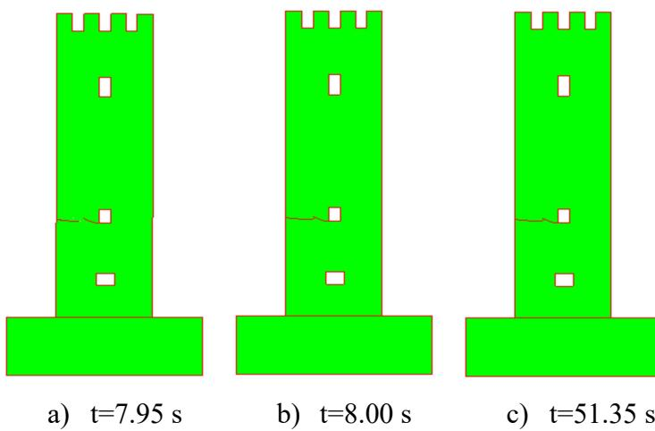
**Slika 74.** Pukotine za ubrzanje  $a = 2.20 \text{ g}$
