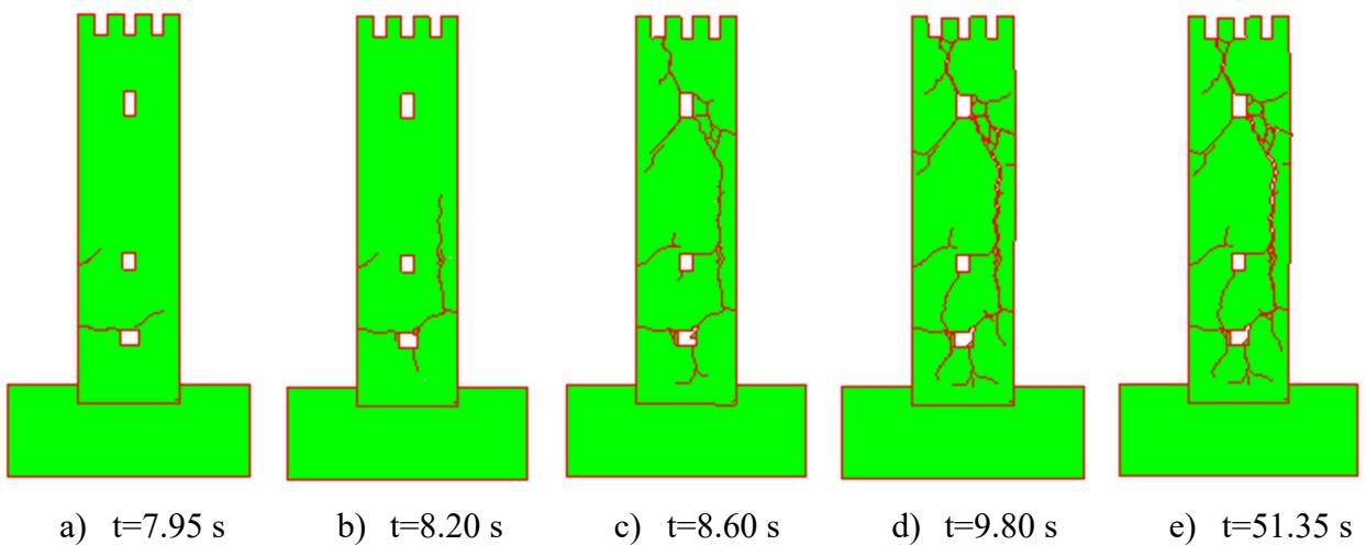
**Slika 98.** Pukotine za ubrzanje  $a = 2.80 \text{ g}$
