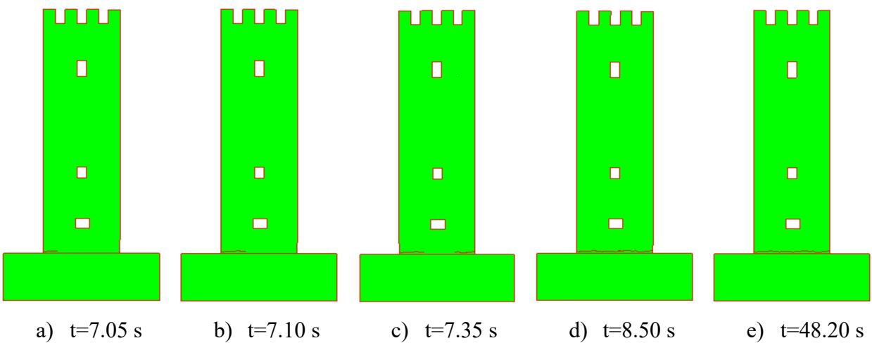
**Slika 15.** Pukotine za ubrzanje  $a=0.30 \text{ g}$
