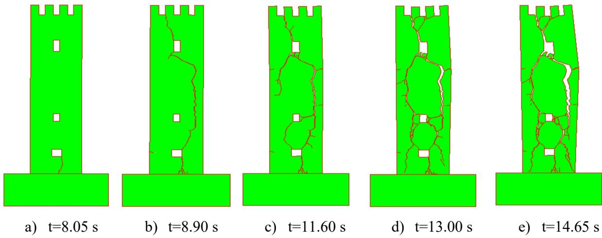
**Slika 13.** Pukotine i konačni slom za ubrzanje  $a=0.75 \text{ g}$
