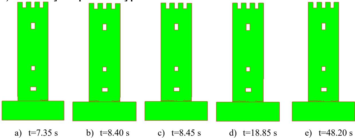
**Slika 14.** Pukotine za ubrzanje  $a=0.25 \text{ g}$
