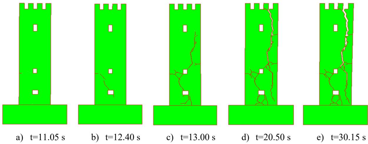
**Slika 35.** Pukotine za ubrzanje  $a = 5.00 \text{ g}$
