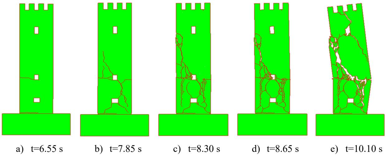
**Slika 86.** Pukotine i konačni slom za ubrzanje  $a = 2.00 \text{ g}$
