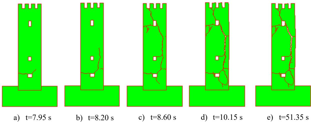
**Slika 97.** Pukotine za ubrzanje  $a = 2.60 \text{ g}$
