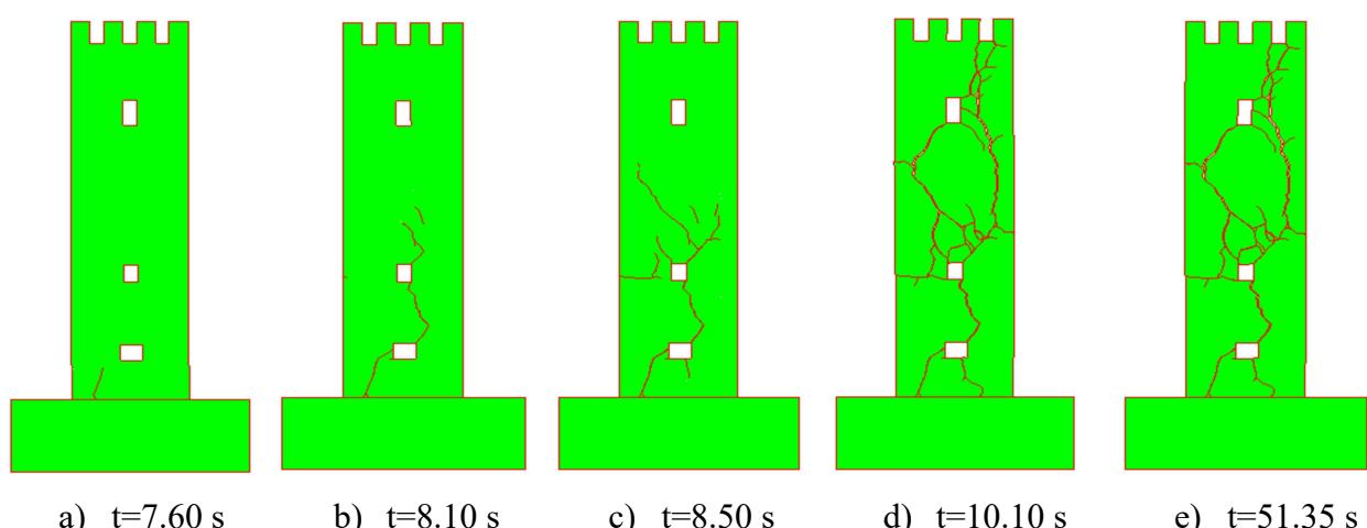
**Slika 76.** Pukotine za ubrzanje  $a = 2.60 \text{ g}$
