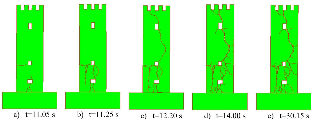
**Slika 37.** Pukotine za ubrzanje  $a = 6.60 \text{ g}$
