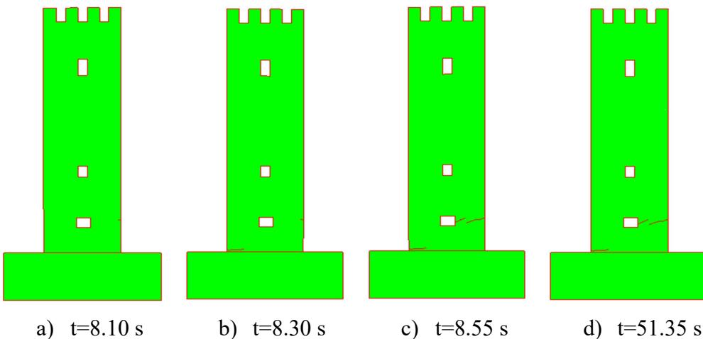
**Slika 88.** Pukotine za ubrzanje  $a = 1.00 \text{ g}$
