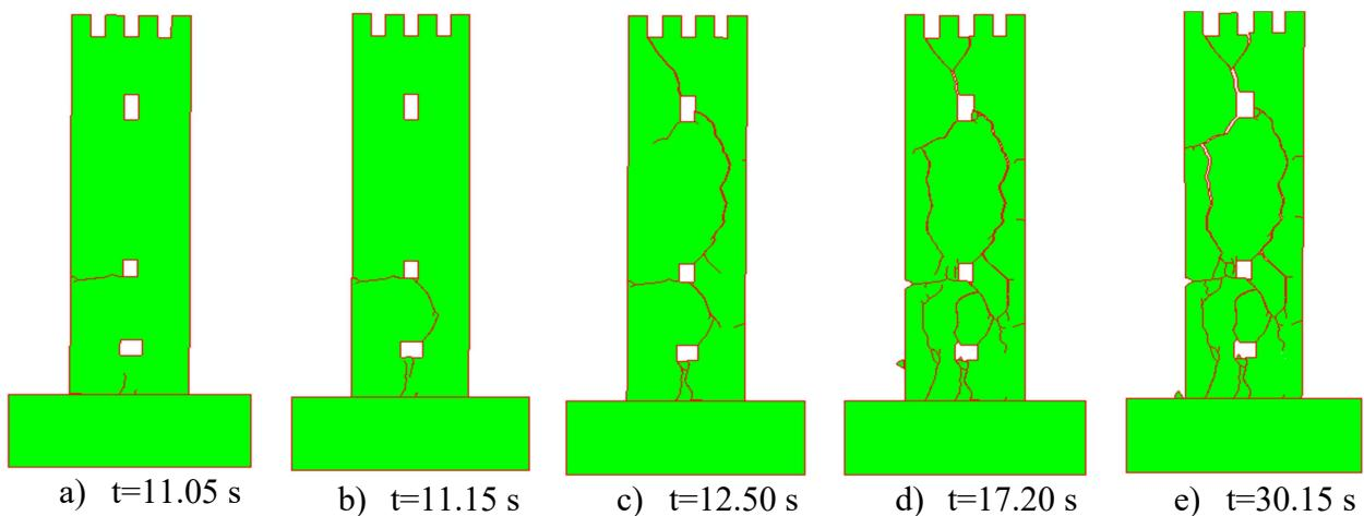
**Slika 36.** Pukotine za ubrzanje  $a = 6.00 \text{ g}$
