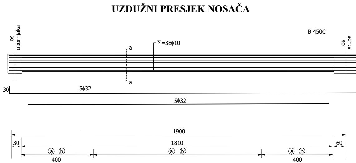
Slika 32. Prikaz armiranja uzdužnog nosača u polju
