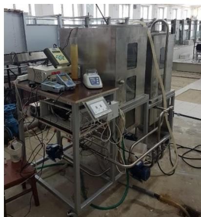
**Slika 1.** Pilot EK-a uređaja instaliran u hidrotehničkom laboratoriju Građevinskog fakulteta Sveučilišta u Zagrebu
