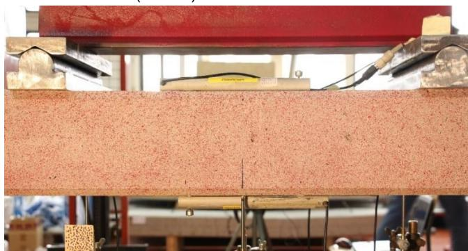
Slika 1. Površina uzorka pripremljena za digitalnu analizu slike
