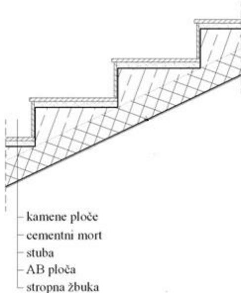
Slika 3: Prikaz slojeva konstrukcije stubišta
