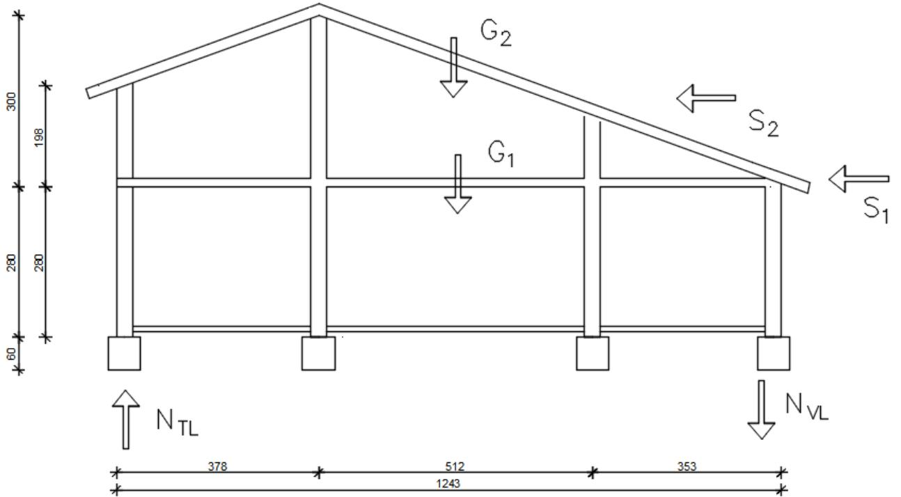
Potresne sile proračunate su po pojednostavljenom postupku. Građevina se nalazi u području Splita za koje se uz povratni period od 475 godina očekuje potres sa ubrzanjem tla  $a_g=0.2g$ . Građevina je temeljena na stjenovitom tlu, dakle pripada klasi tla A, pa slijedi:
