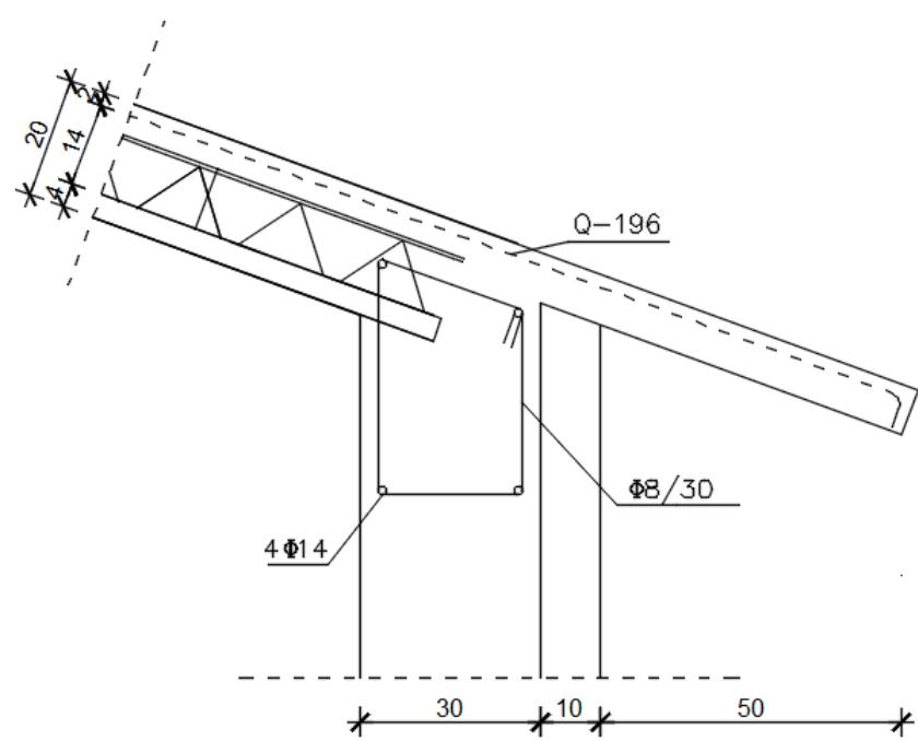
Napomena: Zbog raspona i malih momenata savijanja, proračun potrebne armature greda u prizemlju nije proveden. Za grede u prizemlju usvojene su dimenzije b/h= 30/40 cm, uzudžna armatura 4Φ14 te poprečna armatura Φ8/30.
