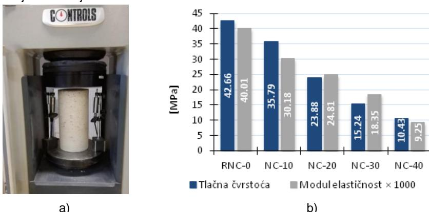
Slika 1. a) Postavke ispitivanja odnosa naprezanja i deformacije; b) Rezultati ispitivanja tlačne čvrstoće i modula elastičnosti na betonskim kockama.
