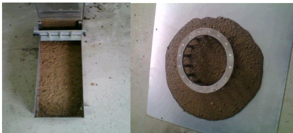
Slika 5.1. Ispitivanje obradivosti u L-box i J-ring [10, 11]
