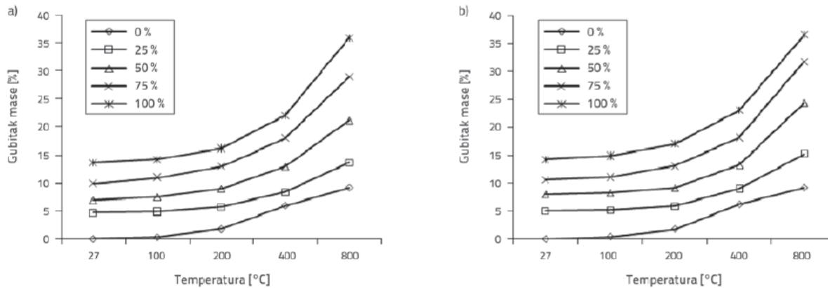
Slika 4.3. Gubitak mase mješavine LWSCC450 izložene visokim temperaturama:
