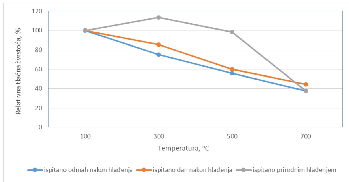
Na grafu 5.7 dane su vrijednosti relativne čvrstoće u odnosu na referentnu temperaturu (100 °C). Prema grafu vrijednosti koje su dobivene razlikuju se od ispitivanja ispitivanja [10] za temperature od 300°C, 500°C, dok je vrijednost za 700°C približno ista. Najveća vrijednost temperature je najzanimljivija jer temperatura požara doseže tu i veće vrijednosti temperature, a kako je vidljivo prema grafu bez obzira na način hlađenja uzorka, čvrstoća opada na 40 % referentne vrijednosti.
