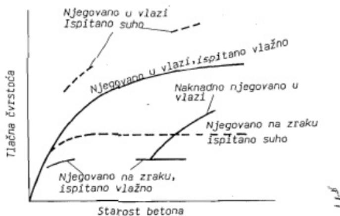
Slika 5.5. Utjecaj njegovanja i vlažnosti uzorka betona na rezultate tlačne čvrstoće[12]
