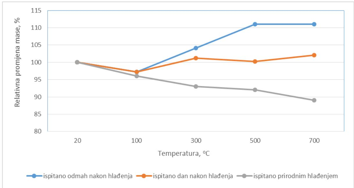
Uspoređujući ispitivanje prisilnim hlađenjem u usporedbi sa prirodnim hlađenjem [10] gdje su mase uzoraka bile smanjene za 4%-11%, u ovom ispitivanju pokazalo se da su mase povećane za 4%-7% u odnosu na početnu masu uzorka sušenog na 100°C, što je posljedica upijanja vode.
