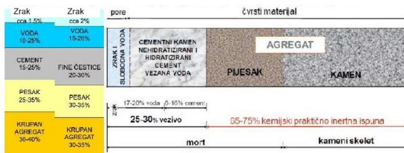
Slika 2.2. Omjer zastupljenosti sastojaka samozbijajućeg betona [9]
