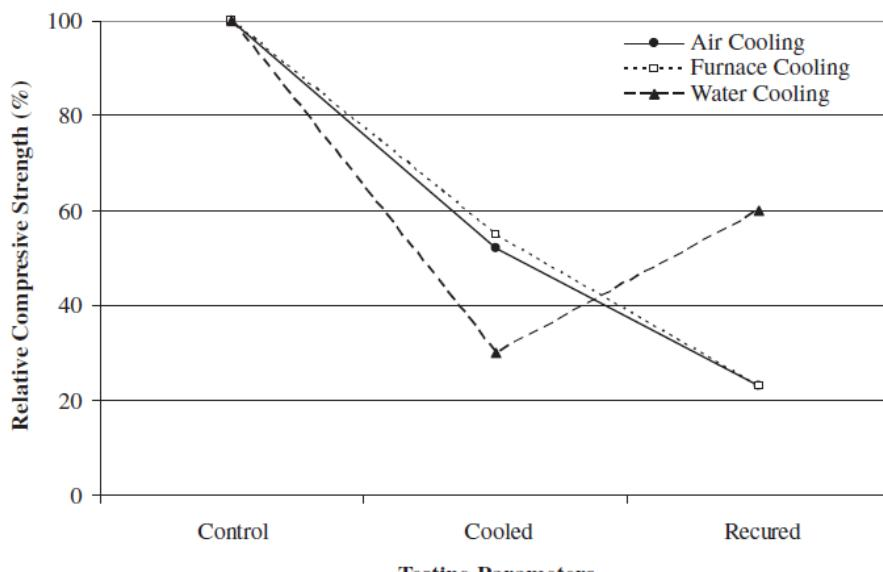
b) Rezultati ispitivanja nakon 600 °C
