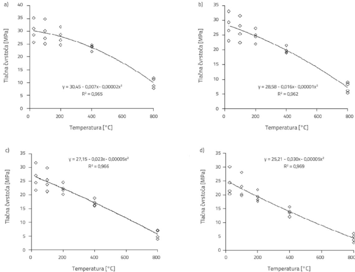
Slika 4.8. Odnos između tlačne čvrstoće i različitih temperatura u laganom samozbijajućem betonu: a) 25 %-tina zamjena u krupnom agregatu; b) 50 %-tina zamjena u krupnom agregatu; c) 75 %-tina zamjena u krupnom agregatu; d) 100 %-tina zamjena u krupnom agregatu [6]
