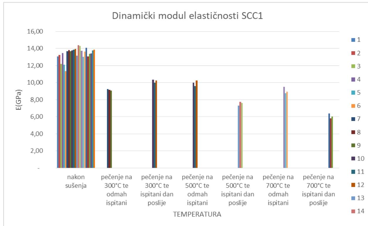
Graf 5.4. – Dinamički modul elastičnosti prosječnih vrijednosti svih uzoraka po temperaturama
