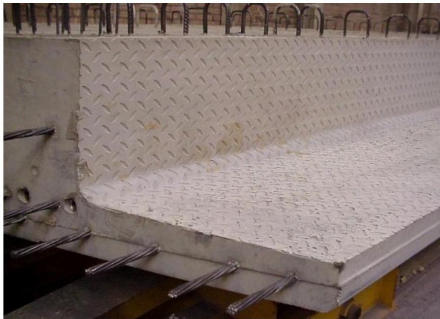
Slika 2.1. Predgotovljeni element od samozbijajućeg betona [8]
