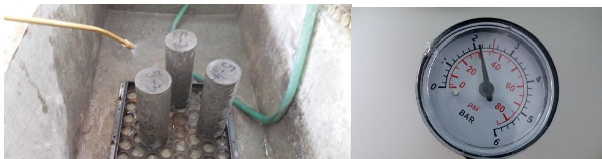
Slika 5.2. a) Hlađenje uzorka vodom; b) vrijednost tlaka u pumpi[5]
