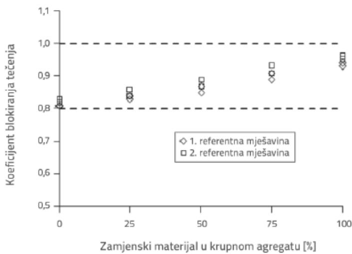
Slika 4.2. Koeficijent blokiranja tečenja lagano samozbijajućeg betona [6]
