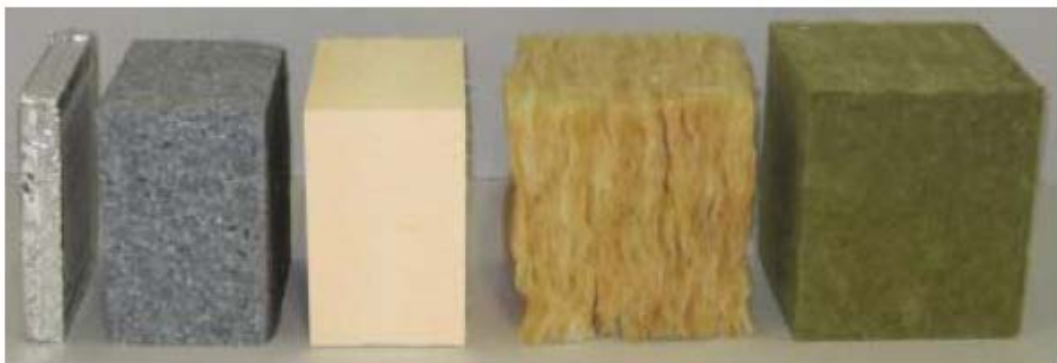
Slika 31. Usporedne debljine za U = 0.3 \text{ W/m}^2\text{K} (VIP, EPS, XPS, mineralna vuna, kamena vuna), [23].
