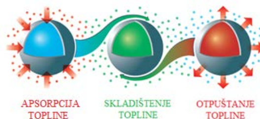
Slika 26. Mehanizam rada PCM-a, [17]
