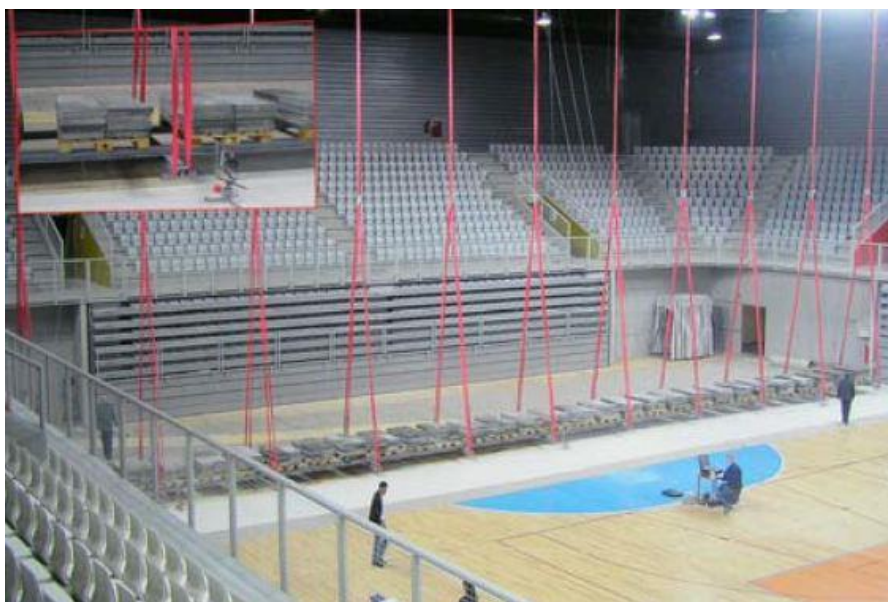
Fotografija 1.1: Statičko ispitivanje rešetkaste konstrukcije sportske dvorane
